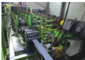
造管機 本体パイプもすべて自社製造。すぐれた精度で製品の信頼性を高めています。
