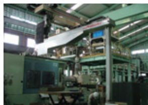
1600t成型機 最新の射出成形機で軽量・強固なプラスチック製床板を製造しています。
